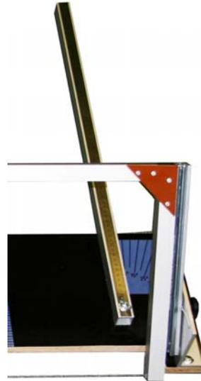
4. Durch drücken des Tasters auf dem Schneidbügel wird der Schneidedraht erwärmt. Die Schneidtemperatur wird innerhalb von 2 Sekunden erreicht. Den Taster so lange gedrückt halten bis der Schneidvorgang beendet ist.
