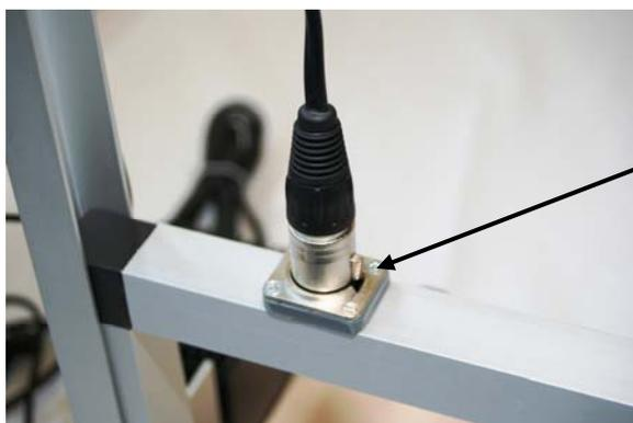
Darauf achten, dass die Nase des Steckers in die Aussparung der der Buchse passt.
